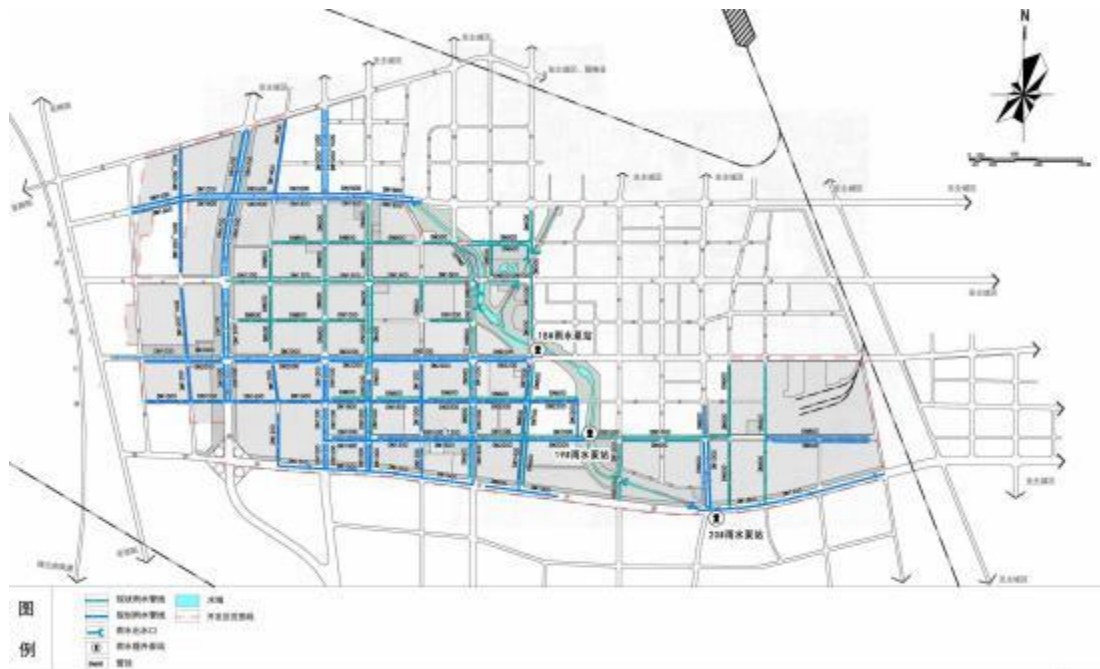
图 1.1-3 现状雨水管网图
